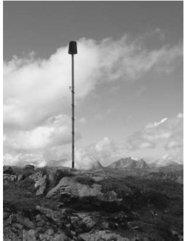
Abb. 3: Der im August 2011 beim Chalberalpe (1'840 m ü. M.) installierte Niederschlagsmesser (Foto: A. Dickert)
